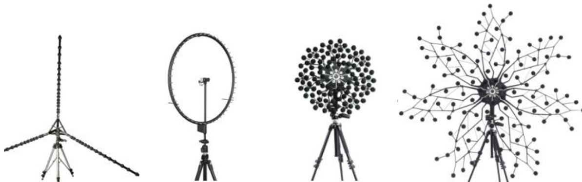
Obr. 1. Možné uspořádání mikrofónů do mikrofonního pole
