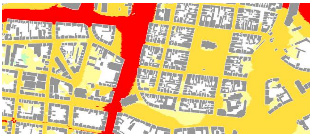
Obr. 5. Výstup hlukového modelování pomocí NoiseModelling z dat Traffic Modeller
